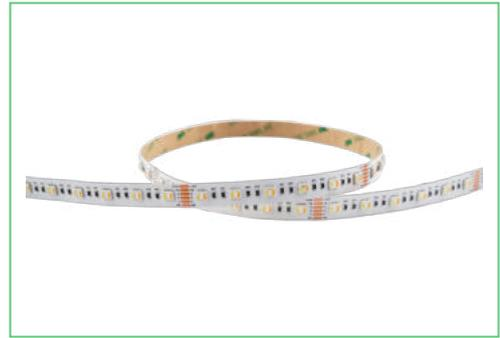
RGBCCT 5in1 LED-Streifen 12 mm – 60 LEDs/m, 24 V, 18 W/m, 2700–6500 K, IP20 & IP65, teilbar alle 100 mm, Konfektionierungen & höhere IP-Schutzarten auf Anfrage.
